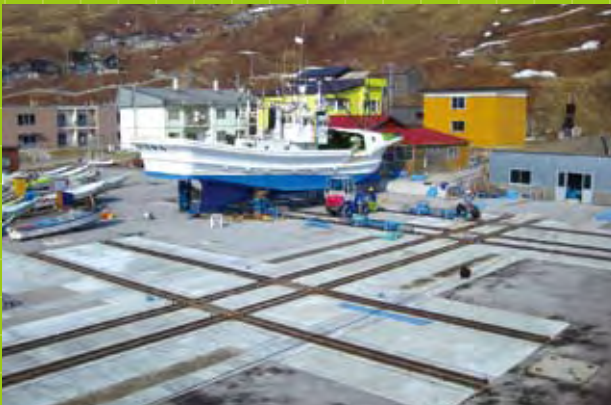
④横移動させ台車を取り外すと上架完了
