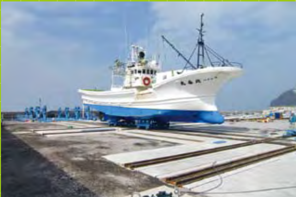
③軌条上をウインチ等で牽引移動(縦移動)
