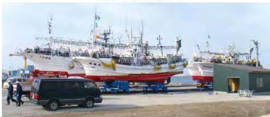
④台車を取り外すと上架完了
