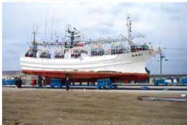
③4点受台車による上架状況※2
