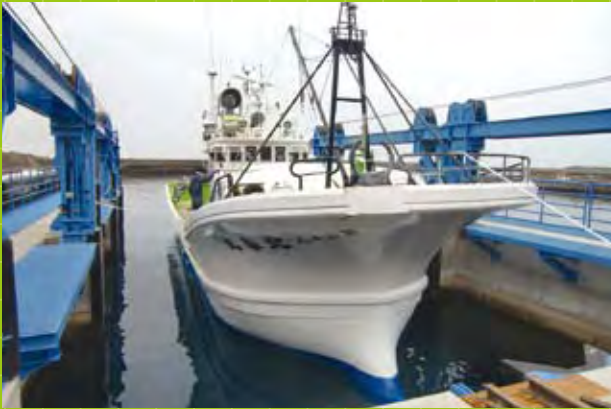
①リフターテーブルと共に水没させた台車上に船を誘導
