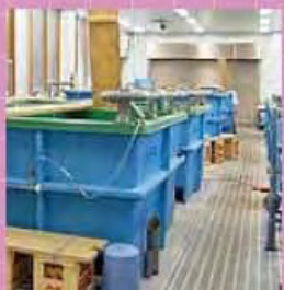
循環式養魚育成システム EC生物濾過装置、泡沫分離装置、紫外線殺 菌装置、連動地流式砂濾過器、水温調整シス テムで構成され、僅かな補給水で済む養魚育 成プラントです。
