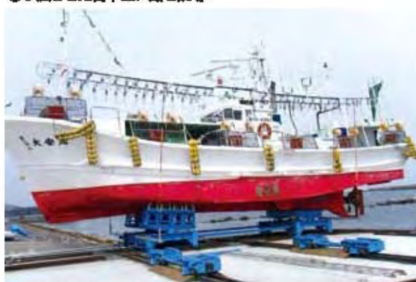
②3点受台車による上架状況※1
