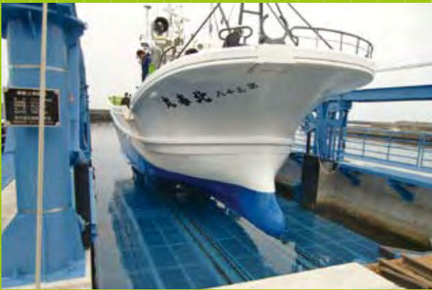
②リフターテーブルによる船舶の持ち上げ
